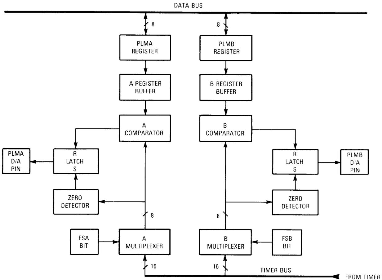
**Figure 17. PLM Block Diagram**
